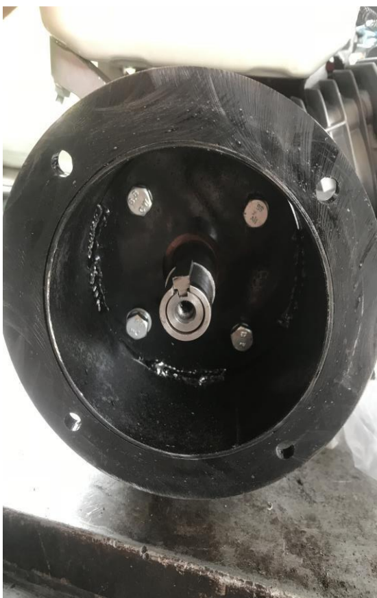
3, Umiestnenie náboja spojky na nový motor
