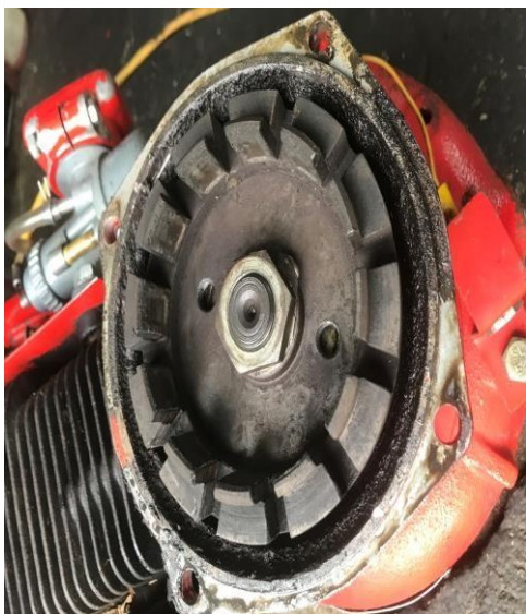
3, Umiestnenie náboja spojky na nový motor
